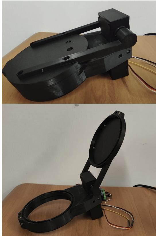
*Figura 4. Piezas impresas en PLA y montadas.*
